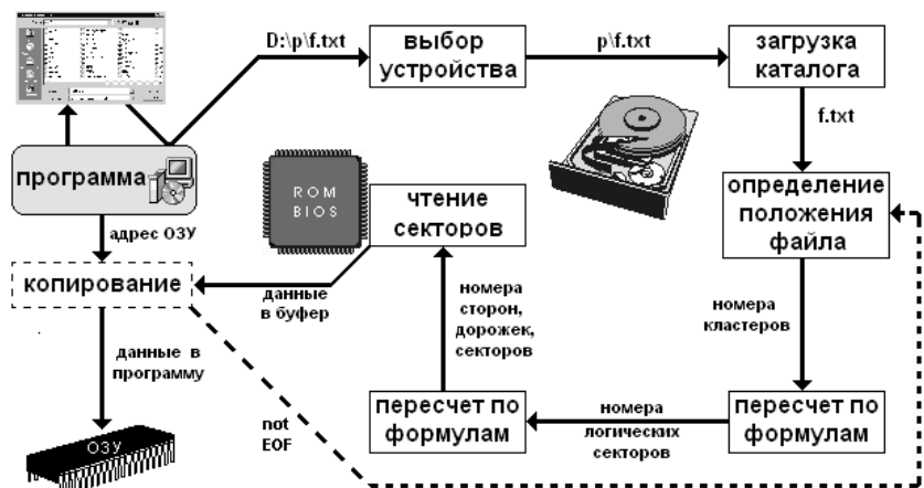
Рис. 2. Полная схема процесса считывания файла
