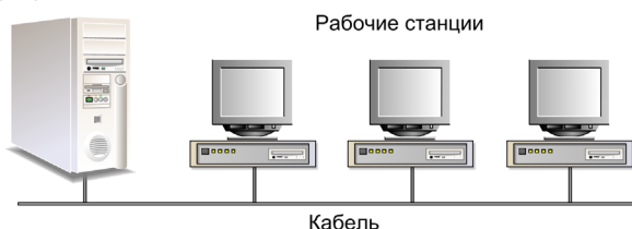
Рис. 1.4. Вариант соединения компьютеров в локальную сеть
